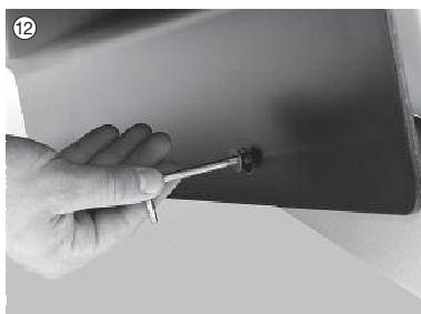
● Setzen Sie Schrauben immer zuerst vorne an, und danach hinten.
