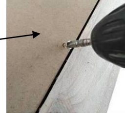
Abb. 29 Führen Sie den Netzstecker durch die äußere obere Abdeckung und befestigen Sie ihn mit 8 4 x 25 mm Schrauben.
