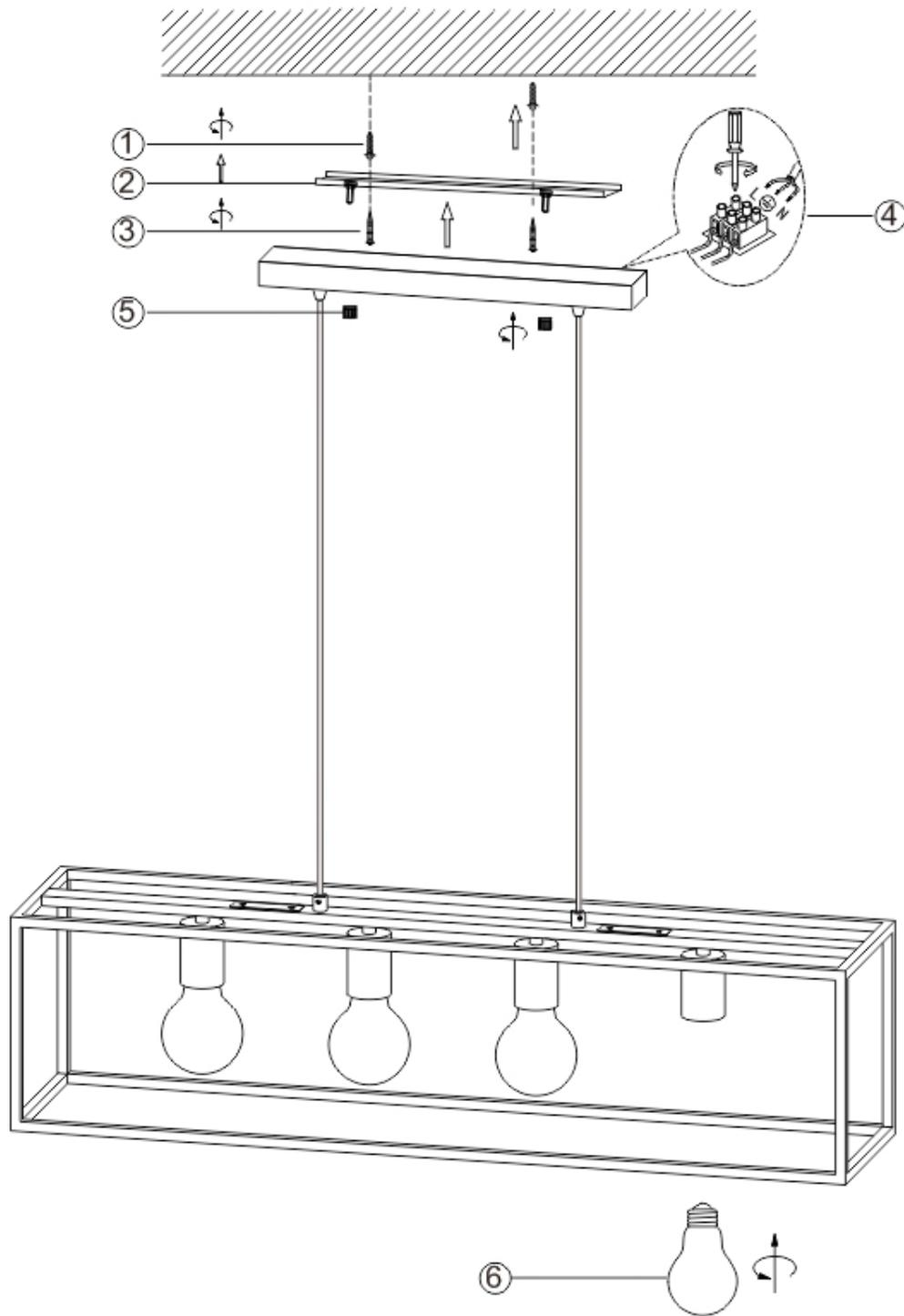
1-3. Bestimmen Sie die Position der an der Decke zu installierenden Lampe und bohren Sie zwei Löcher in die Decke, die der Position der beiden Löcher in der Deckenhalterung entsprechen. Führen
