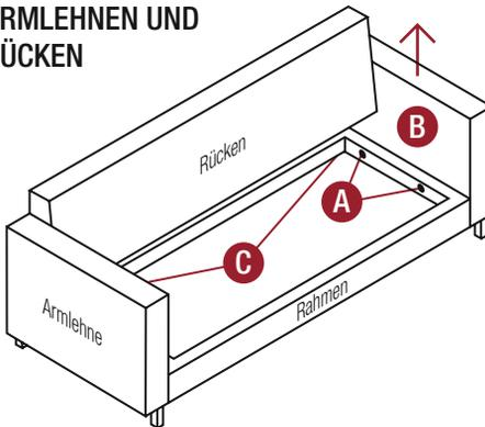
1. Die vier Schrauben **A** an der inneren Seite des Metallrahmens lösen (je zwei links und rechts).
