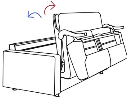
3. Unterseite des Sitzteils anheben und aufschlagen.
