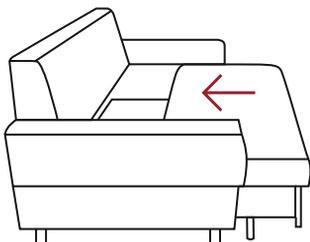
3. Abschließend das Sitzteil mit leichtem Ruck bis zum Anschlag einschieben, sodass dieses einrastet.
